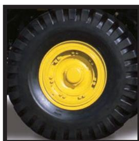
Las llantas del tipo de brida facilitan el desmontaje/instalación de los neumáticos en las ruedas.
