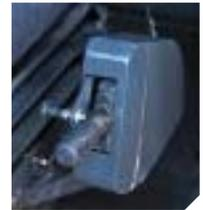
» Palanca suave que facilita el volteo. Un sensor de posicionamiento sirve para controlar el volquete reduciendo el choque que se produce al bajarlo.
