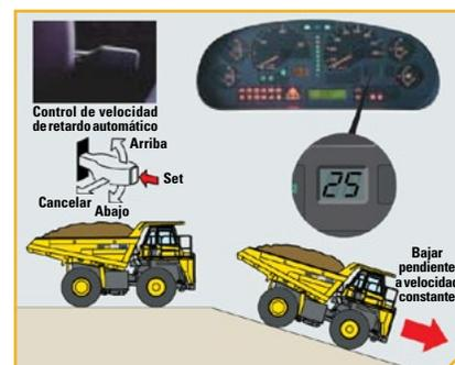
» **Frenos de disco múltiple húmedos con control hidráulico total y retardador**
