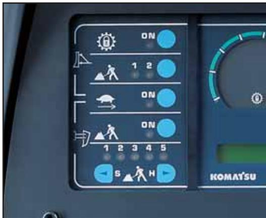
Panel de control del deslizamiento de las zapatas de oruga
