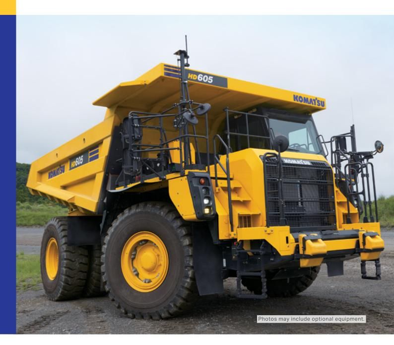
**Engine power** Gross: 610 kW / 2000 min<sup>-1</sup> Net:  $590 \, kW / 2000 \, min^{-1}$
